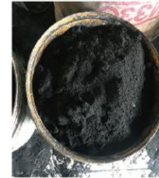
Les copeaux de caoutchouc obtenus par broyage des pneus sont ensuite transformés en poudre
